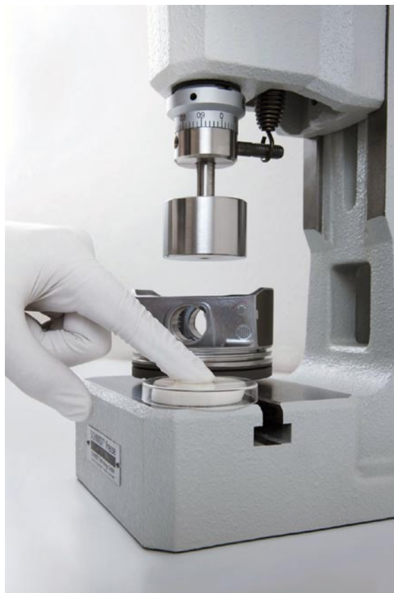
Partikelstempel für die schnelle und trockene Extraktion von Partikeln an Montageanlage und -einrichtungen sowie auf Fahrwegen
