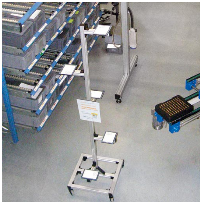
Beim Partikelmonitoring der Montageumgebung wird pro 20 m 2 Hallenfläche ein Messpunkt festgelegt, an dem Partikelfallen in drei unterschiedlichen Höhen platziert werden
