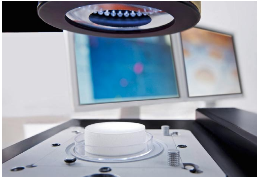
Die extrahierten Partikel können licht- und rasterelektronenmikroskopisch ausgewertet werden
